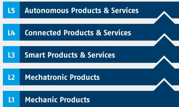
**L1** Die Funktion der mechanischen Komponente steht im Fokus, die Basisanforderungen der Applikation werden erfüllt. Die Steuerungshoheit liegt allein bei der übergeordneten Steuerung. Eine Prozesstransparenz kann nur durch zusätzliche Sensorik erreicht werden.
